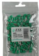
Наконечники НШВИ предназначены для оконцевания методом опрессовки гибких многопроволочных медных проводников. Они трансформируют концы многожильных проводов в монолитные штифты. Наконечники НШВИ являются удобной альтернативой обязательному облуживанию концов многожильных проводников при подсоединении к клеммам.
