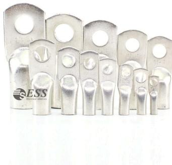
Облегченная серия силовых наконечников ESS используется для оконцевания проводов и кабелей с медными жилами посредством опрессовки для последующего болтового соединения проводника с оборудованием или шиной. Наконечники изготавливаются из медных труб различного диаметра.
