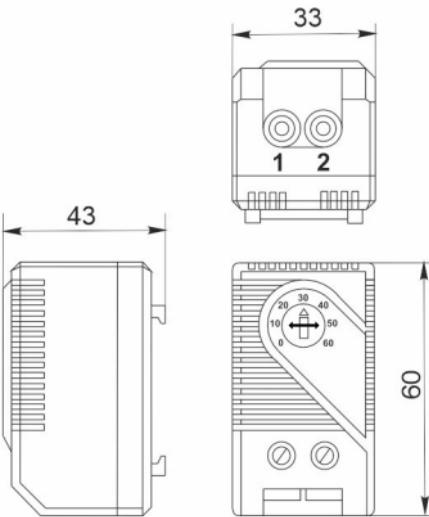
Габариты терморегулятора КТО и КТС ESS
