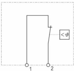
Схема подключение КТО и KTS ESS
