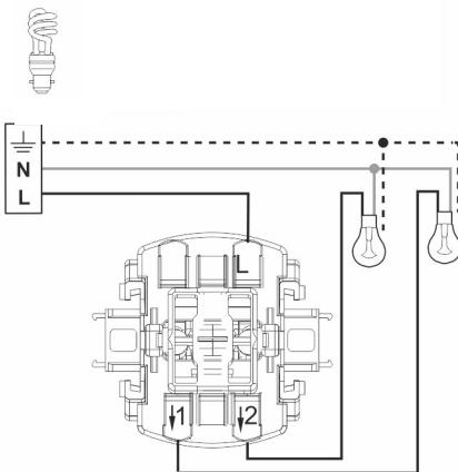
Схема подключение 2-клав. выключателя
