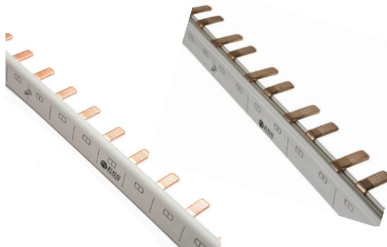
Шины соединительные производятся ESS на номинальные токи 63 и 100 А, на одно-, двух-, трех- и четырехфазную нагрузку. Шины соединительные представляют собой пластины, выполненные из меди (шины на 100 А – из луженой меди), закрепленные в корпусе из диэлектрического материала, не поддерживающего горение, и выпускаются стандартной длиной 1 метр.
