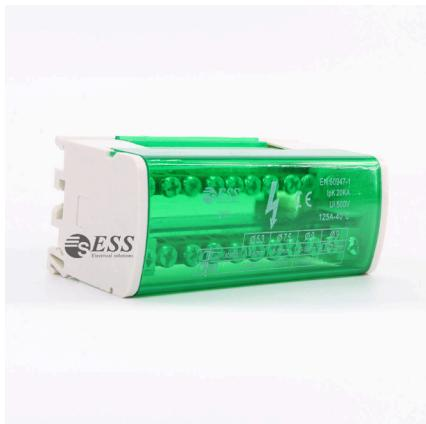
Нулевые шины в корпусе используются в щитовом оборудовании для подключения нулевых рабочих (N) и нулевых защитных (PE) проводников. Допускается применение кросс-модулей в качестве фазных проводников. К распределительному блоку (кросс-модулю) 160А можно подключить дополнительную шину к нижнему и верхнему полюсу. Для подключения к верхнему полюсу необходимо вынуть пластиковую перегородку.
