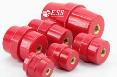
Шинные изоляторы серии SM ESS применяются для крепления токопроводящих шин внутри силовых шкафов или других устройств, для неподвижной фиксации и изоляции частей, находящихся под напряжением, от корпуса и панелей сборки с последующим подключением силовых проводников для распределения электроэнергии внутри щита. Крепление шинного изолятора осуществляется с помощью болта и шайбы, входящих в комплект поставки, к монтажной пластине или корпусу с одной стороны и к токоведущей шине – с другой.
