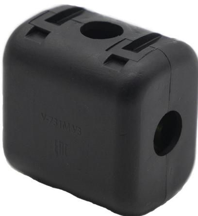
Ответвительный сжим (орех) ESS предназначен для ответвлений от магистральных линий медных и алюминиевых проводов напряжением до 660 В, с предварительным снятием изоляции на месте установки, без разрезания проводника.
